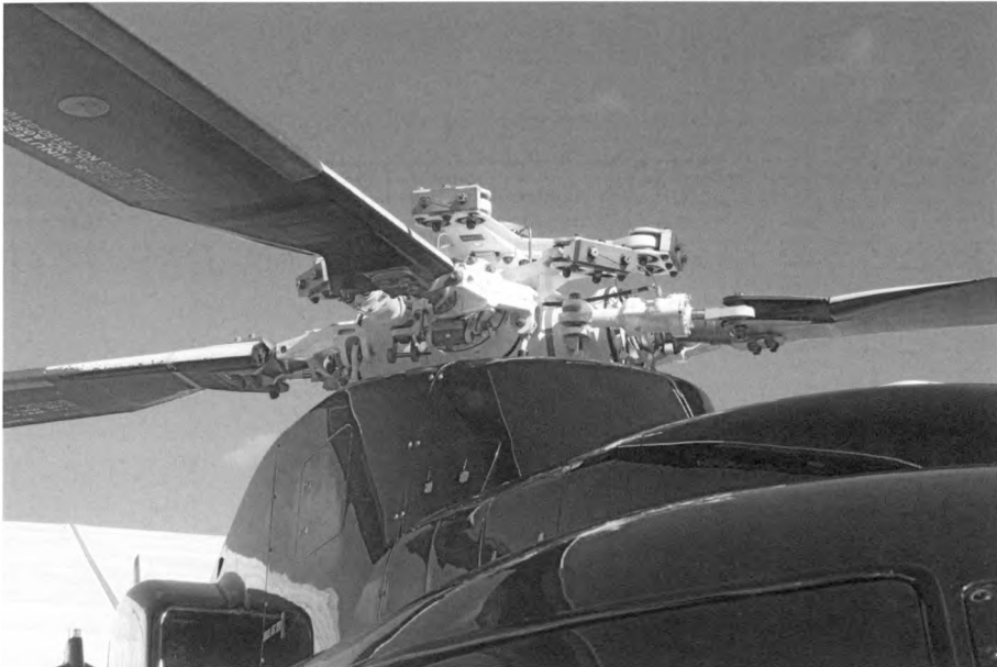
그림 10.8.5 오일 승강장용 상업 헬리콥터(날개 폭 24 in, 길이 24 ft, 무게 각각 200 lb; 외팔보의 강성은 선단에서 6 ft/100 lb임; 헬리콥터의 총무게는 빈 상태일 때 7000 lb이고 적재시 13,000 lb임)
