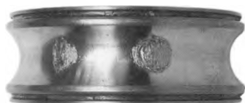
図5.4 軸受内輪に生じたフレーキング 〔日本精工 (株) New Bearing Docter より〕
