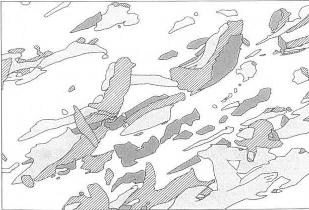
図 21.7 壁面乱流の壁近傍の構造。流れは左から右へ。低圧部（斜線部）の左右にイジェクション（うすい網点）とスウィープ運動（濃い網点）が見られる（原図はカラー）。
