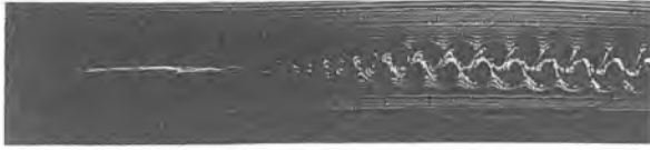
図 18.1 変曲点不安定の例 (二次元平板の後流の渦列) 平板の長さ (25mm) に基づくレイノルズ数, 約 7000.
